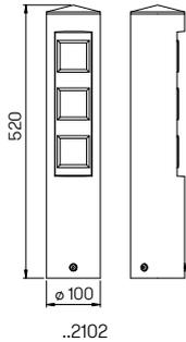
mit 3 Schutzkontaktsteckdosen mit erhöhtem Berührungsschutz mit Netzanschlussklemmen 4 x 4 □ Aluminiumguss anschlussfertig mit Montageplatte
