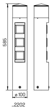
mit 3 Schutzkontaktsteckdosen mit erhöhtem Berührungsschutz mit austauschbaren LED Komponenten und integriertem Überspannungsschutz Lichtfarbe warmweiß, 3000 K, dimmbar mit Netzanschlussklemmen 4 x 4 □ Aluminiumguss anschlussfertig mit Montageplatte, Acrylglas weiß
